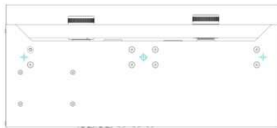
▲Die Bodenplatte des ONE - 3/8" UNC in der Mitte und M6 Schraubenlöcher
